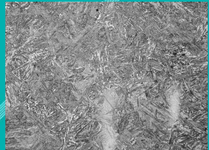
擴散焊接工件(模具鋼 P20)
