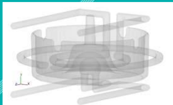
(b)擴散焊接的流道設計
